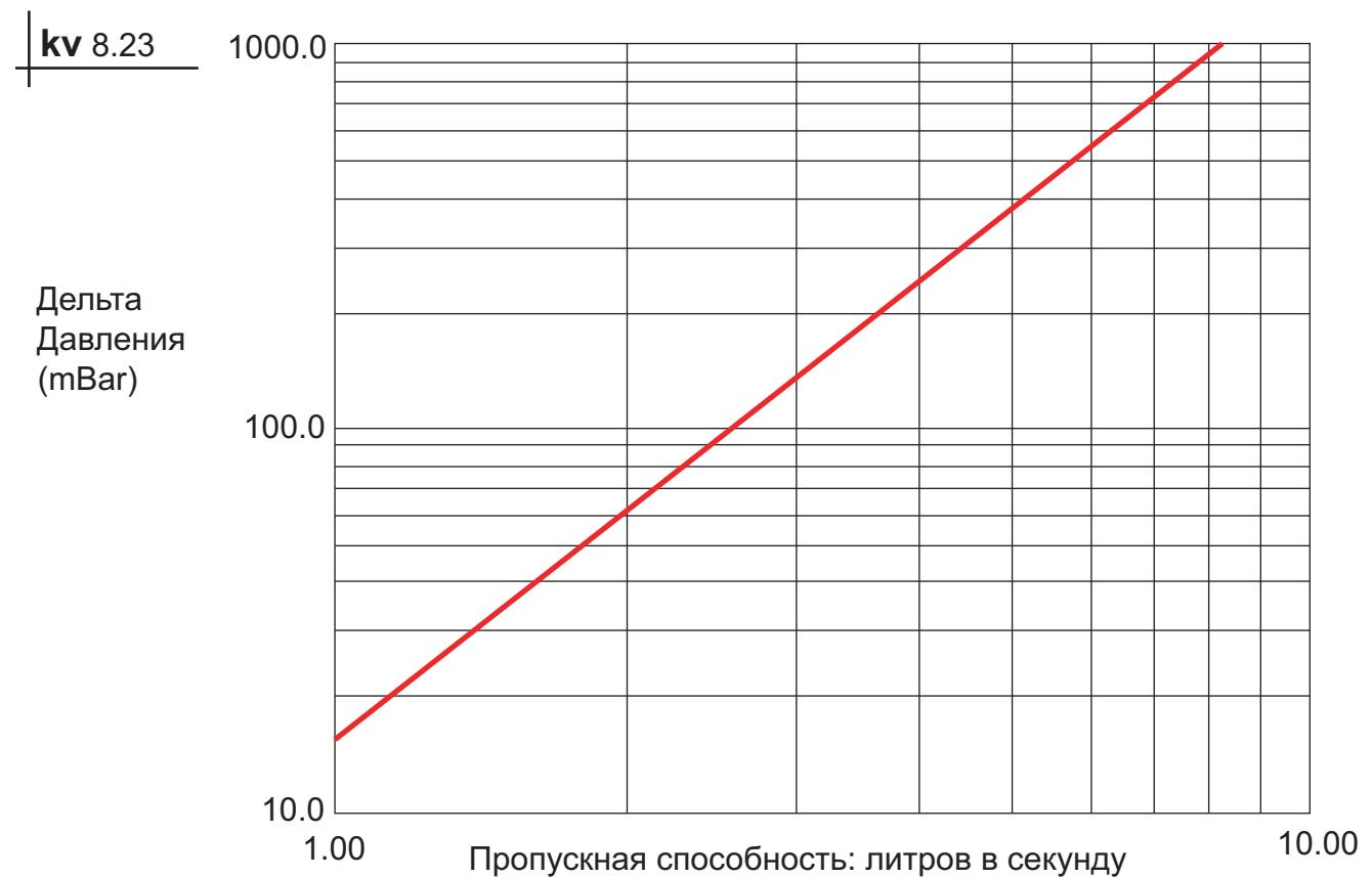
Диаграмма 990844/ТА/2: зависимость падения загрузки от пропускной способности магнитного противоизвесткового аппарата ELCLA4A Ø 1.1/2".
