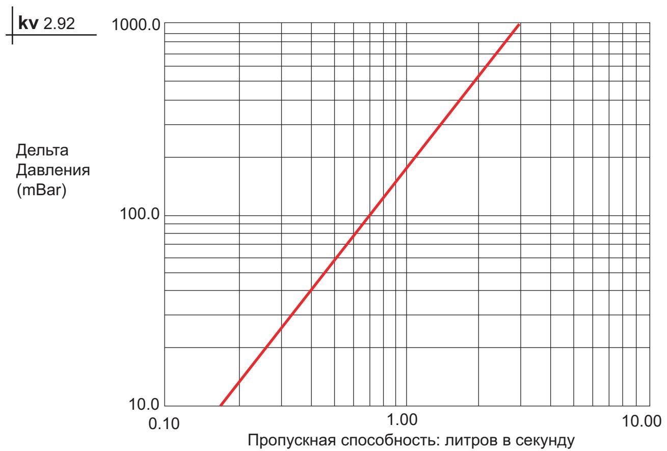
Диаграмма 981559/3: зависимость падения загрузки от пропускной способности магнитного противоизвестного аппарата ELCLA2 Ø 3/4".
