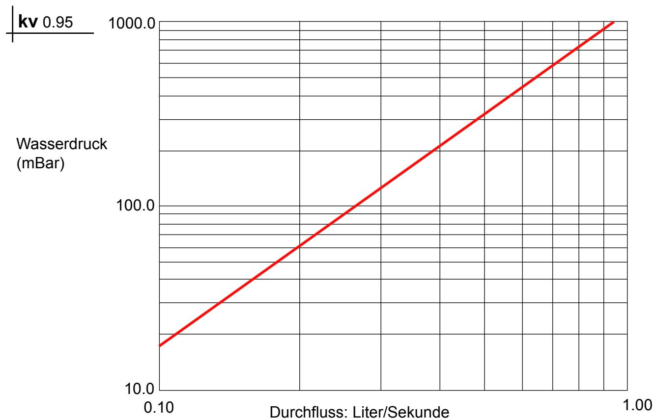
Diagramm 981559/1: Angabe vom Druckverlust durch den magnetischen Entkalker MiniElcla Ø 1/2" und 3/4".
